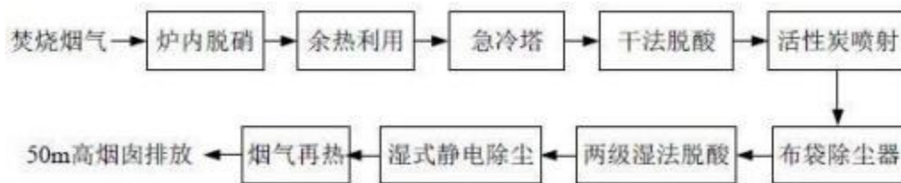
图 4-6 焚烧炉烟气处理工艺流程
